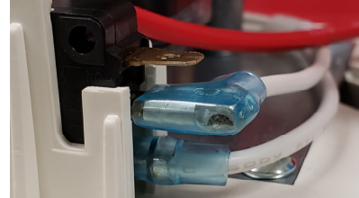
Fig. 5: Contacts de flotteur de haut niveau en position N.O.
